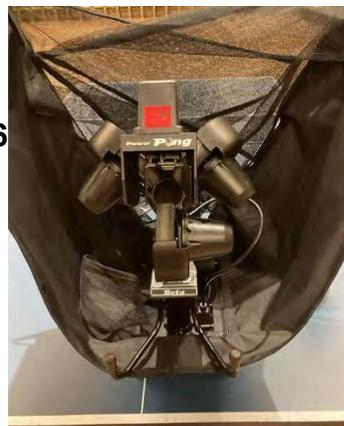
3. 供給チューブの2つ目の昇降リングがちょうど見えるまで、ロボットの頭部を供給チューブの上に取り上げます(写真 2-7)。ロボットの頭部を固定するため、送球高度調整ノブを軽く締め、ロボットの頭部が落ちない程度に固定します。
