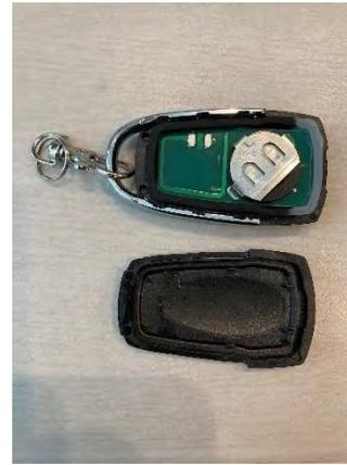
2. 電池の入った回路基板をパッドから外します。
